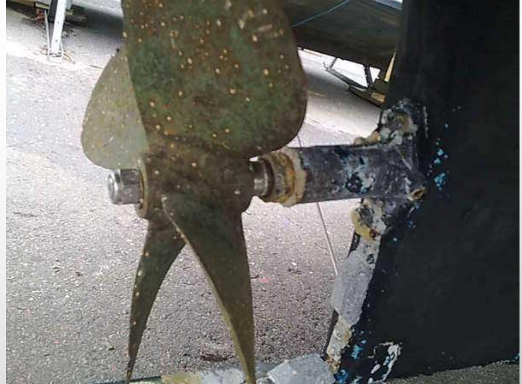
Sinkanode bør monteres på propellaksel
